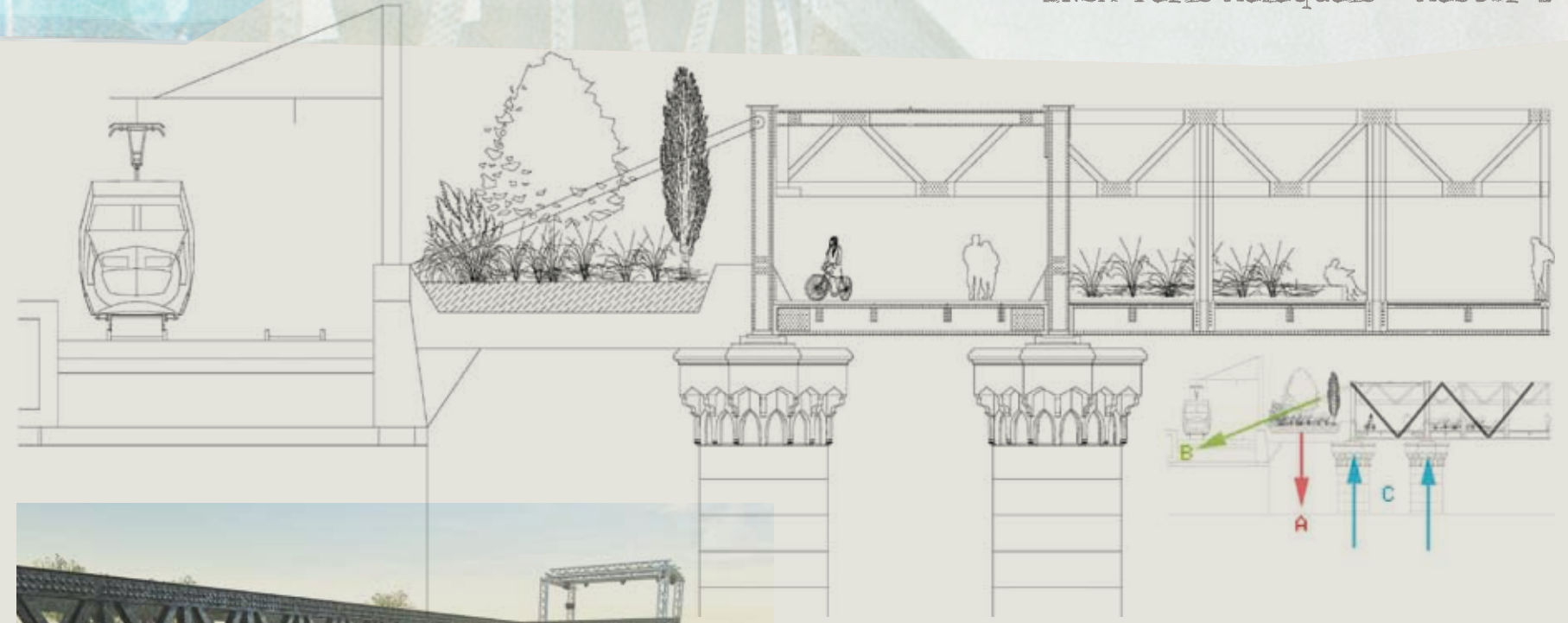
Le projet exploite la capacité portante de la passerelle ferroviaire. Elle est doublée de part et d'autre par deux encorbellements et propose côté pont TGV un jardin protecteur et côté Garonne une large promenade.
